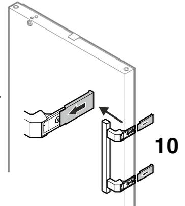
4. Bolzen im Scharnierwinkel umsetzen.
