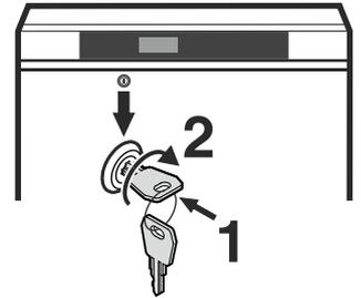
Um das Gerät wieder aufzusperren, muss in der selben Reihenfolge vorgegangen werden.
