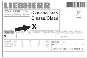
Die Klimaklasse ist auf dem Typenschild aufgedruckt.
