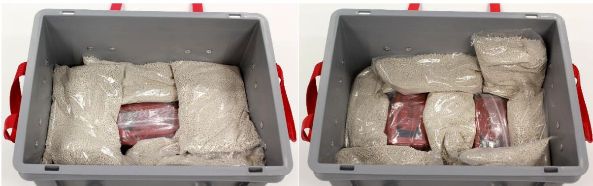
Abb. 5: Box mit einem Akku (links) und zwei Akkus (rechts) mit dicht gepackten Löschgranulatkissen
