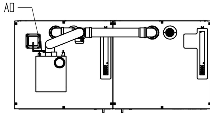
AD: Anschluss Druckluft
